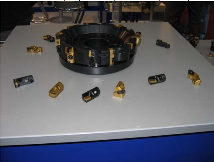
Kuva 3 vaihtoteräpalojen kiinnitysmekanismeja sovitepaloilla
