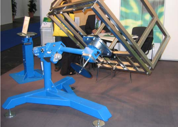
Kuva 2 monikäyttöinen ja joustava jigirakennelma
